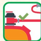
En las instalaciones de butano/propano, **vigile la correcta colocación del regulador y el buen estado del mismo;** así como el tubo flexible y su caducidad.
